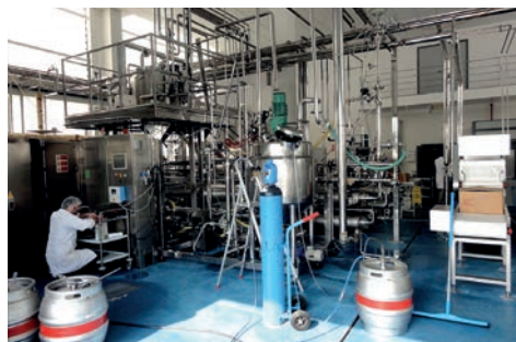
Imagen 2. Equipo de alta presión hidrostática (izquierda) de las instalaciones del IRTA, Monells (Leida). Equipo de radiofrecuencia (derecha) de las instalaciones del CNTA, San Adrián (Navarra).
