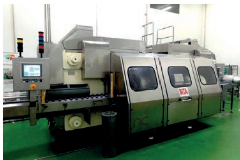
Imagen 2. Equipo de alta presión hidrostática (izquierda) de las instalaciones del IRTA, Monells (Leida). Equipo de radiofrecuencia (derecha) de las instalaciones del CNTA, San Adrián (Navarra).
