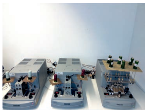
Imagen 4. MOCON. Medidor de la tasa de transferencia de oxígeno (OTR).
