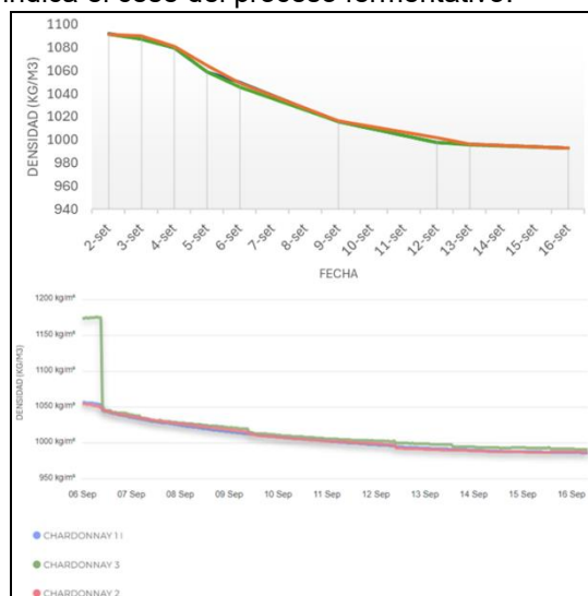
Figura 3: Ejemplo de seguimiento de densidad de las vinificaciones de Chardonnay inoculadas con Saccaromyces cerevisiae durante la fermentación alcohólica medido manualmente con densímetros y con sensores Densios
