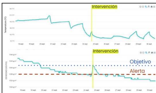
Figura 4: Ejemplo de seguimiento de la densidad y la temperatura durante la fermentación alcohólica medidos con densímetros en bodega externa para la elaboración de vino dulce natural
