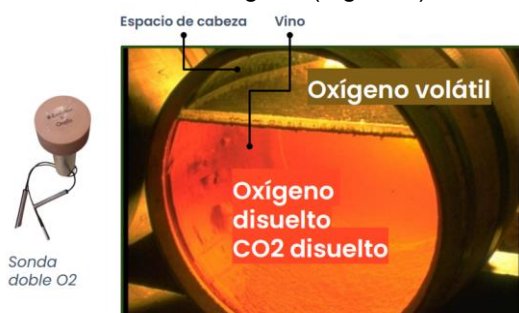
Figura 5: Infografía del doble sensor capaz de medir la concentración de oxígeno gaseoso y disuelto
